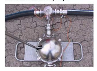
Handmembranpumpe zum Anschütten der Gefahrgutumfüllpumpe (dahinter) mit Hilfe des Dreiwegehahns und des Schauglases einbauen. Reihenfolge:
