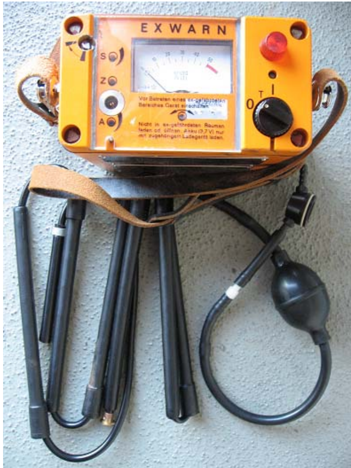
Abb. 2: a) Ein altes Ex-warngerät (Fa. Dräger) mit Verlängerungsschlauch und Gummiball-Pumpe zum Ansaugen. b) Ein modernes Dräger X am 2000, das parallel Ex [%UEG], O 2 [Vol.-%] CO [ppm] und H 2 S [ppm] erfasst Foto © Wickert; .
