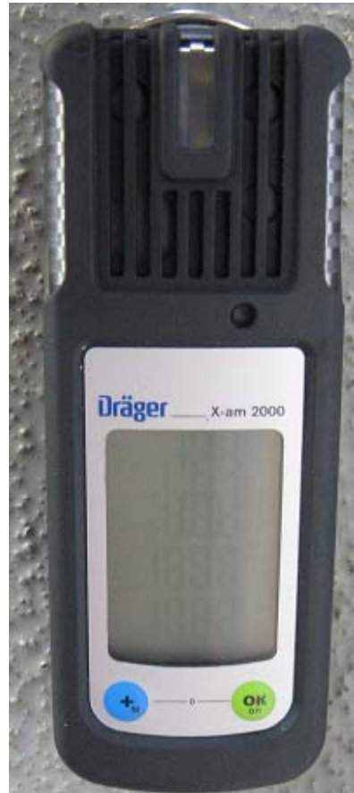
Abb. 2: a) Ein altes Ex-warngerät (Fa. Dräger) mit Verlängerungsschlauch und Gummiball-Pumpe zum Ansaugen. b) Ein modernes Dräger X am 2000, das parallel Ex [%UEG], O 2 [Vol.-%] CO [ppm] und H 2 S [ppm] erfasst Foto © Wickert; .
